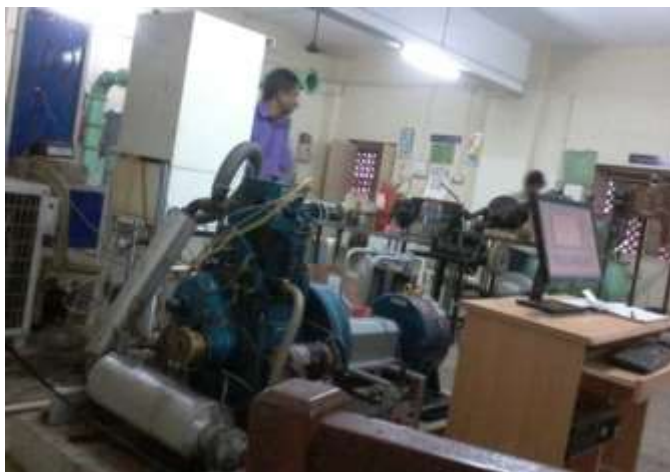
Fig. 3.11 Engine test rig.
