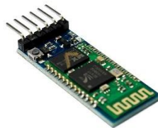
Fig. 7. HC 05 Bluetooth Module
